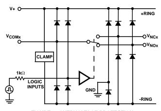
FIGURE 9. OVERVOLTAGE PROTECTION
