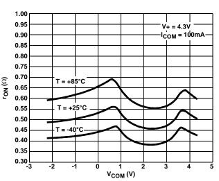
FIGURE 13. ON-RESISTANCE vs SWITCH VOLTAGE
