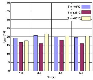
FIGURE 20. TURN - OFF TIME vs SUPPLY VOLTAGE
