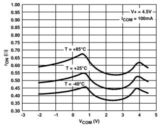
FIGURE 12. ON-RESISTANCE vs SWITCH VOLTAGE
