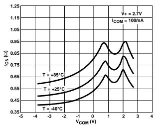
FIGURE 14. ON-RESISTANCE vs SWITCH VOLTAGE
