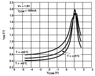
FIGURE 15. ON-RESISTANCE vs SWITCH VOLTAGE
