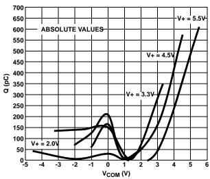
FIGURE 17. CHARGE INJECTION vs SWITCH VOLTAGE
